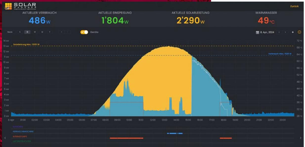
Einbindung der Wärmepumpe mittels bidirektionaler Schnittstelle (LAN). Dadurch ist eine feinere Regelung möglich. Die Wärmepumpe schaltet am Tag ein.
